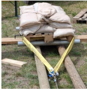
Abb. 13: Anschlag der Palette mit Sandsäcken
